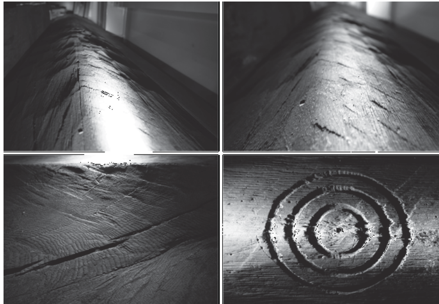
Figur 12. Stavarnas bågform har frekvent huggits från kant till mitten (a). Staven har då stått på högkant när den huggits. Vissa stavar är mer prismatiska och andra är mer rundade efter att de formats, möjligtvis med en skave (b). Stavarnas bågform och det v-formade avslutet på staven har huggits med yxa (c). De koncentriska cirklarna har snarare skrapats än skurits med tanke på de hackande spåren (d). Fotograf: Gunnar Almevik.
