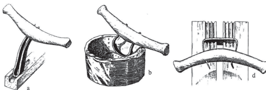
Figur 6. Gösta Berg har tolkat Mästermyrsverktygen ur ett etnologiskt perspektiv och visualiserar en tolkning om skaftning och verktygsanvändning i en serie teckningar (Berg 1983:36, fig. 5). Det finns med detta etnologiska perspektiv en tillsynes självklar logik i verktygsformerna; att skavens böjda egg är uttänkt för urgröpning av runda former som träskålar (b), och att den dubbla profilen i dragjärnet är avsett för att forma två ämnen samtidigt (d). Ur ett hantverkligt perspektiv ställer sig logiken emellertid annorlunda. Vi kan tala om en praktisk logik, där samma profil på vardera sidan av ett stopp så som i järnet SHM 21 592:57 är tänkt att användas i båda arbetsriktningarna vid exempelvis motträ, vresigt virke och kvistar. Att en av de två profilerna är mer sliten, vilket är fallet med Mästermyrfyndets profiljärn SHM 21 592:57, kommer sig av att hantverkaren vanligtvis har preferens om en arbetsriktning. Ett annat exempel på alternativ logik gäller skaven SHM 21 592:54 som sannolikt inte använts för att gröpa ur träskålar men som fungerar utmärkt att hyvla med. Eggen är svagt böjd liksom en skrubbyvel. Dragjärnet SHM 21 592:55 har bara en tene eller skalk, vilket mycket väl kan vara den ursprungliga utformningen. Verktyget används för att göra notspår och skaftet har då sannolikt varit rakt i tenens riktning och möjligtvis också ganska långt.
